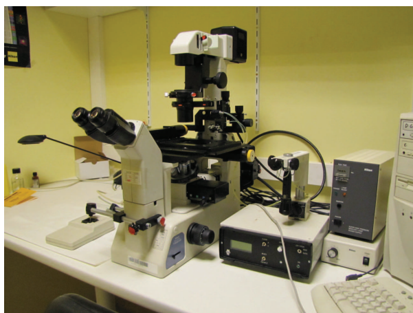
Figure 2-5: Le microscope à épifluorescence du laboratoire utilisé lors de ce travail de thèse.
