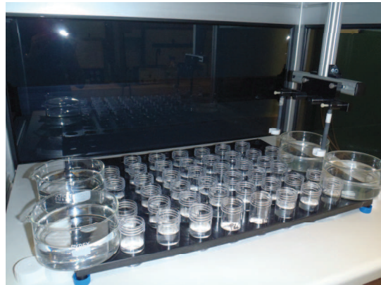
Figure 2-2: Photographie du robot « Dipping robot » utilisé au laboratoire pour la construction automatisée des PEMs sur lamelles de verre de 12 ou de 18 mm de diamètre.
