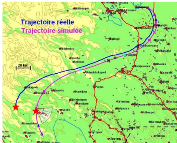
Figure 1.4. Prédiction de trajectoire (violet) et trajectoire réelle (bleu) d'un vol ballon à Kiruna. Les étoiles rouges représentent la séparation entre le ballon et la nacelle. Source : SSC Esrang, Suède.
