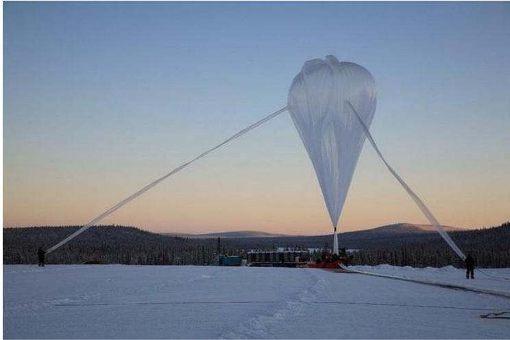
**Figure 3.7.** Photographie d'un ballon stratosphérique ouvert avant son lâcher. (CNES).
