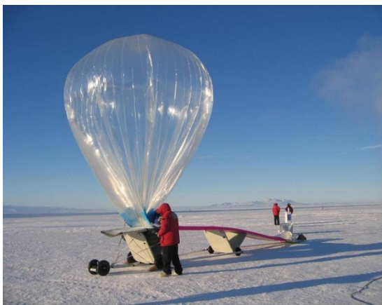
Figure 3.4. Préparation d'un ballon pressurisé stratosphérique avant son lâcher. (CNES)
