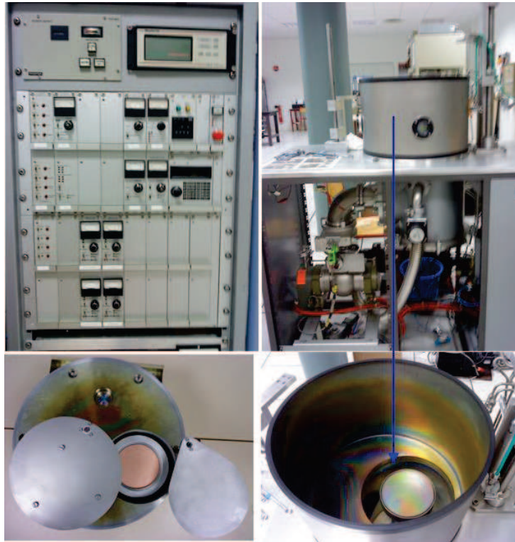
Figure B1 Dispositif expérimental pour le dépôt de CMC sur le substrat de silicium et verre par la technique de pulvérisation cathodique
