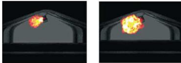
Figure 1-21 : Visualisation d'une flamme par la culasse, richesse stœchiométrique, à 10 et 25° Vilebrequin après l'allumage (Aleiferis et al. [43])
