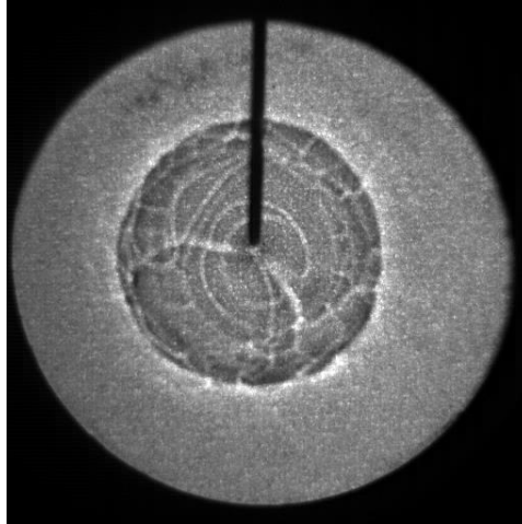
Figure 1-15 : Image de flamme laminaire obtenue par ombroscopie à 10 Bar et 400K présentant des structures cellulaires
