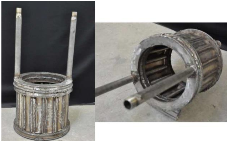
Figure 5 – Échangeur gaz brûlés-air pressurisé
