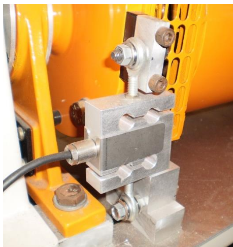
Figure 11 – Capteur de force monté "en balancier" sur la génératrice
