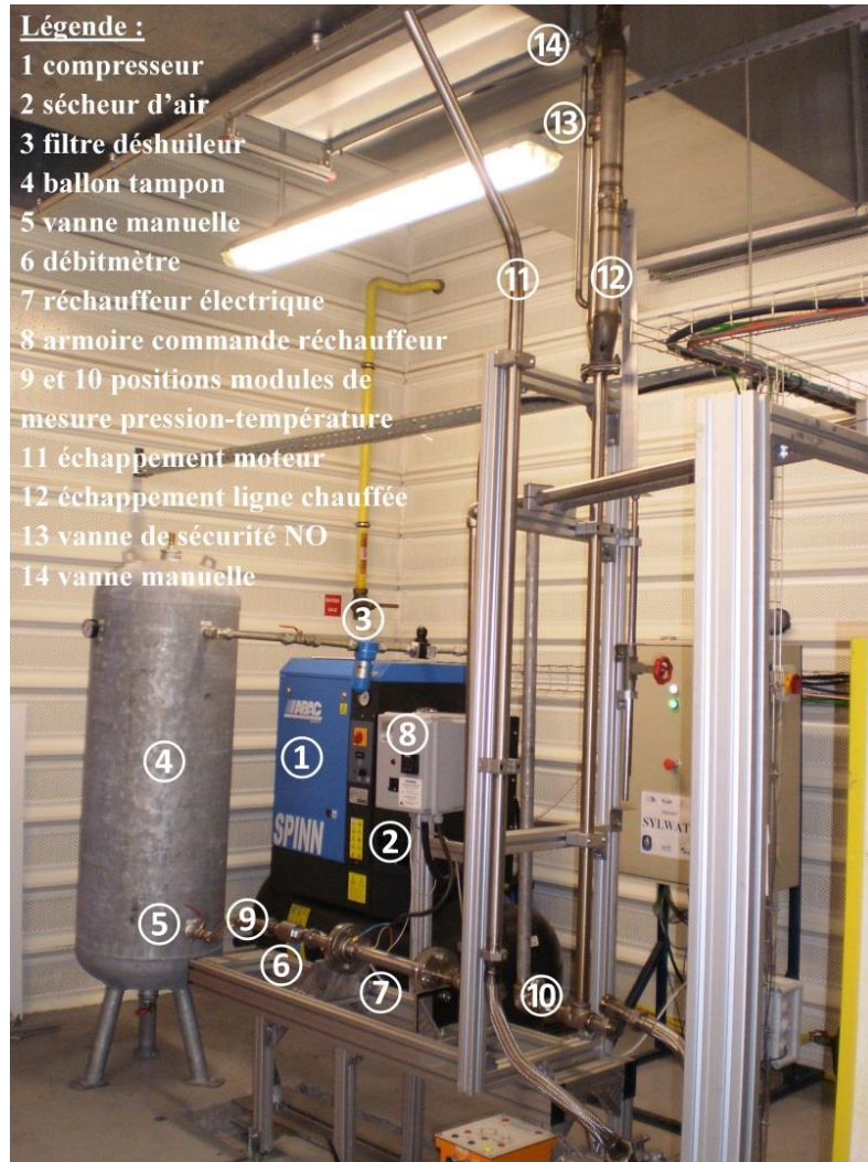
Figure 8 – Ligne d'air comprimé chauffé
