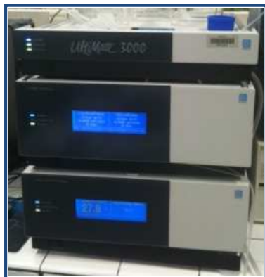
Système Ultimate 3000 (Dionex) composé d'une pompe DGP-3600 et d'un gestionnaire de débit FLM-3100
