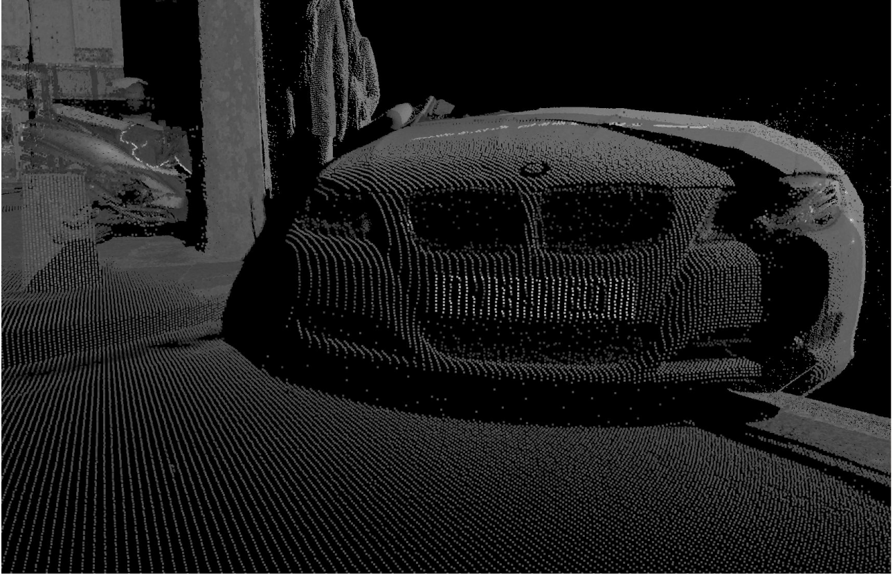
FIGURE 8.21 – Illustration de la résolution atteinte par des capteurs laser nouvelle génération. Il est aisé de distinguer la face avant d'un véhicule de marque allemande.
