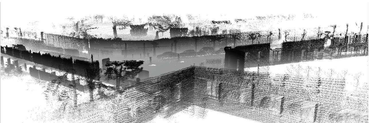
FIGURE 1.4 – Exemple de données acquises par un laser rotatif de type Velodyne HDL-64E. Le dégradé de gris est fonction de l'altitude des points laser. [faible :gris → fort :noir]
