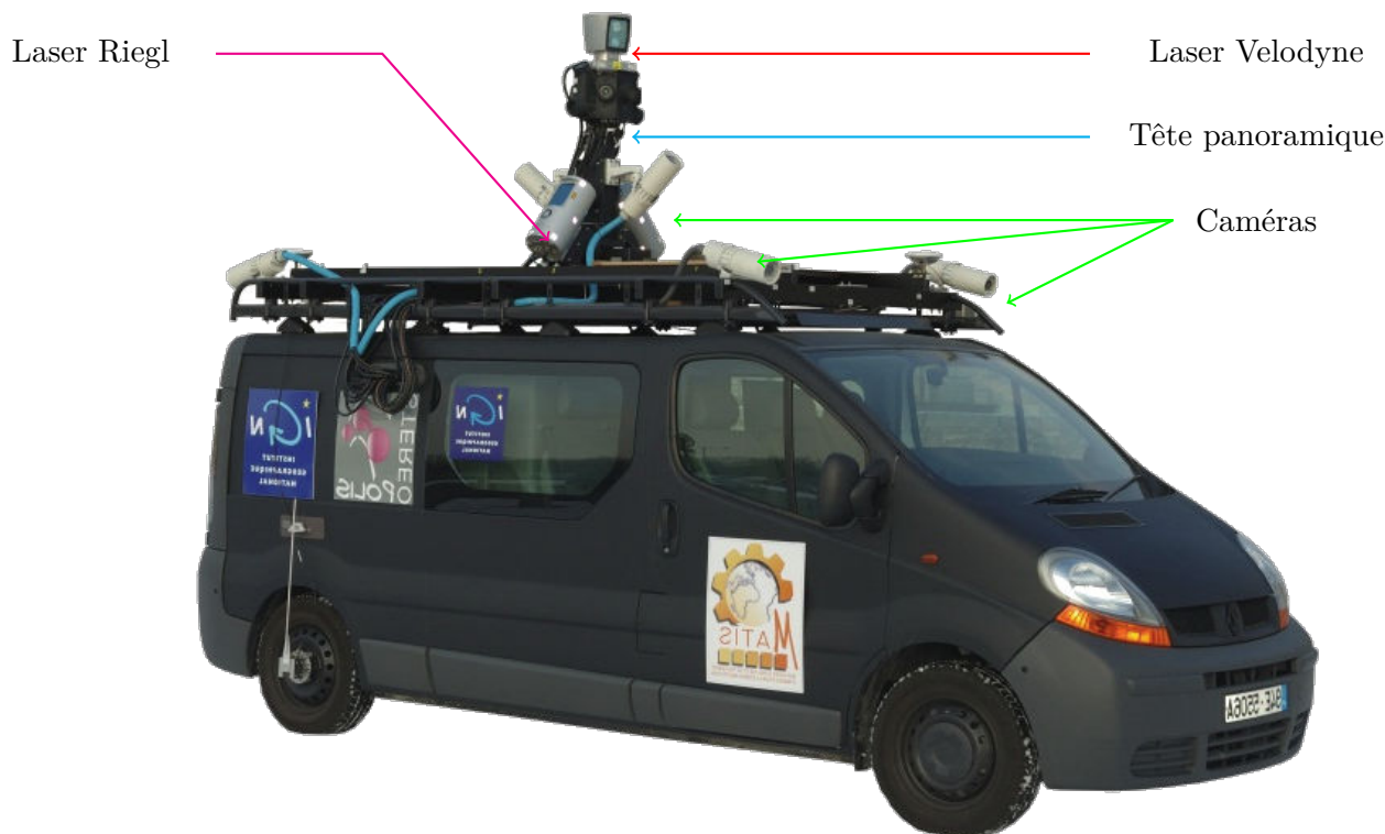
FIGURE 1.1 – Véhicule de cartographie mobile terrestre de l'IGN
