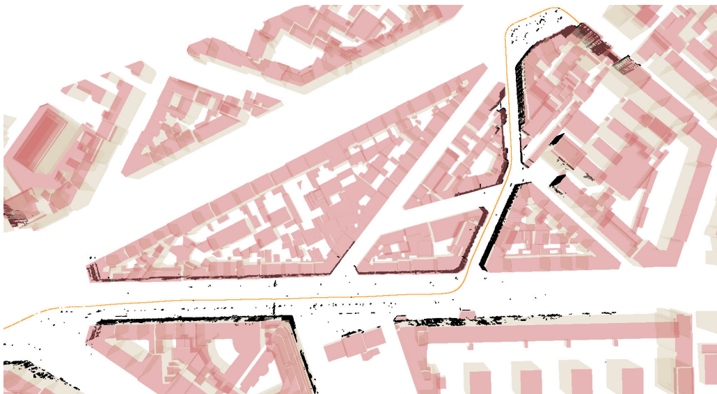
FIGURE 2.4 – Superposition du nuage laser avec le modèle géométrique 3D sur le jeu de données Mairie 12 . Les toits des bâtiments sont représentés en rouge et les façades en beige, le nuage de points laser en noir et la trajectoire du véhicule en orange. A noter que sans recalage des données, l'initialisation par notre véhicule est très proche du modèle.
