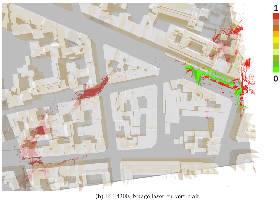
FIGURE 8.20 – Recalage d'un nuage de points dont la dérive est simulée par une centrale inertielle de type Xsens MTI-G. Le nuage de points est tellement dégradé initialement par rapport à la solution souhaitée qu'il est impossible pour la méthode de recaler les données correctement.
