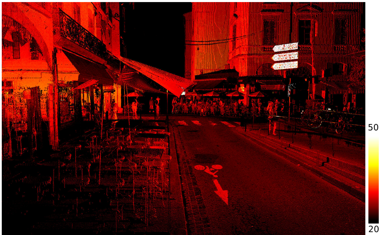
FIGURE 5.14 – Illustration de la résolution atteinte par des capteurs actifs nouvelle génération de type RIEGL VQ-250. Cette figure représente une rue de la ville de Toulouse. La teinte de couleur est fonction de l'intensité retour obtenue au niveau du capteur laser.
