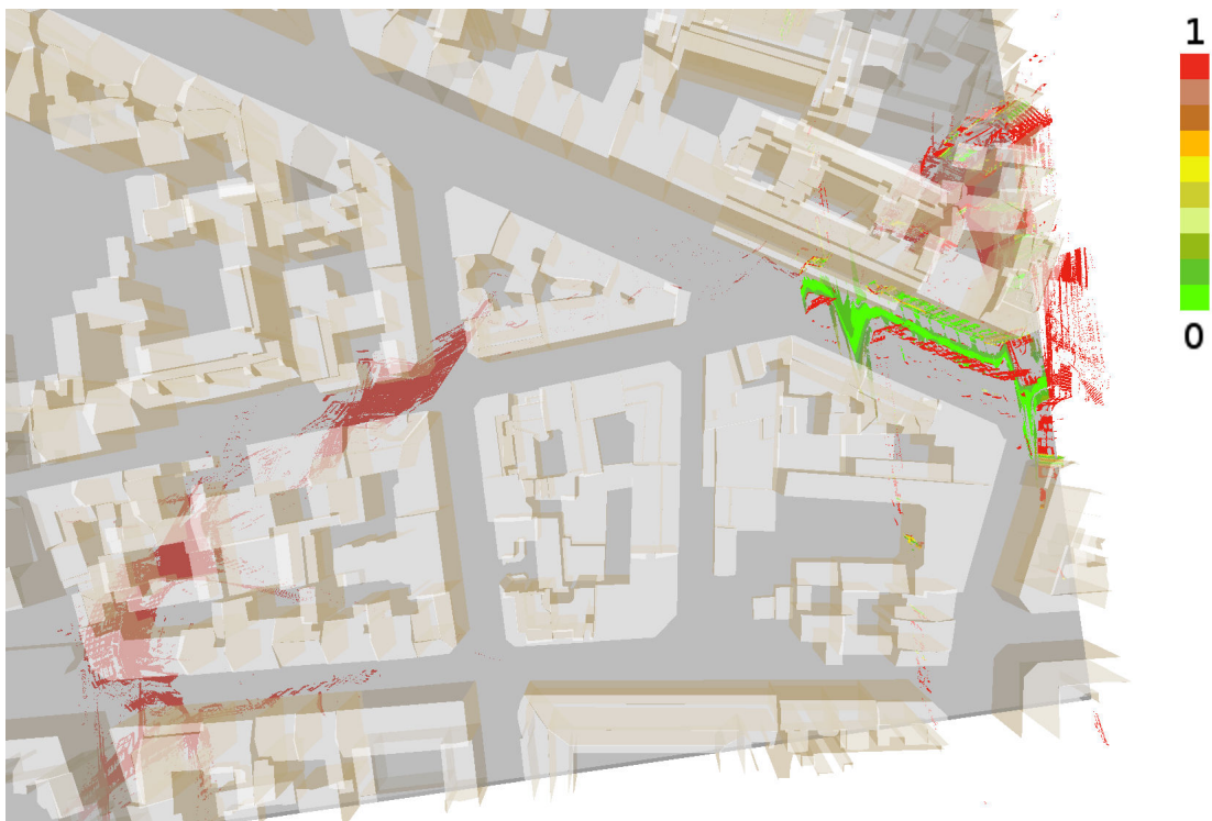
FIGURE 8.20 – Recalage d'un nuage de points dont la dérive est simulée par une centrale inertielle de type Xsens MTI-G. Le nuage de points est tellement dégradé initialement par rapport à la solution souhaitée qu'il est impossible pour la méthode de recaler les données correctement.
