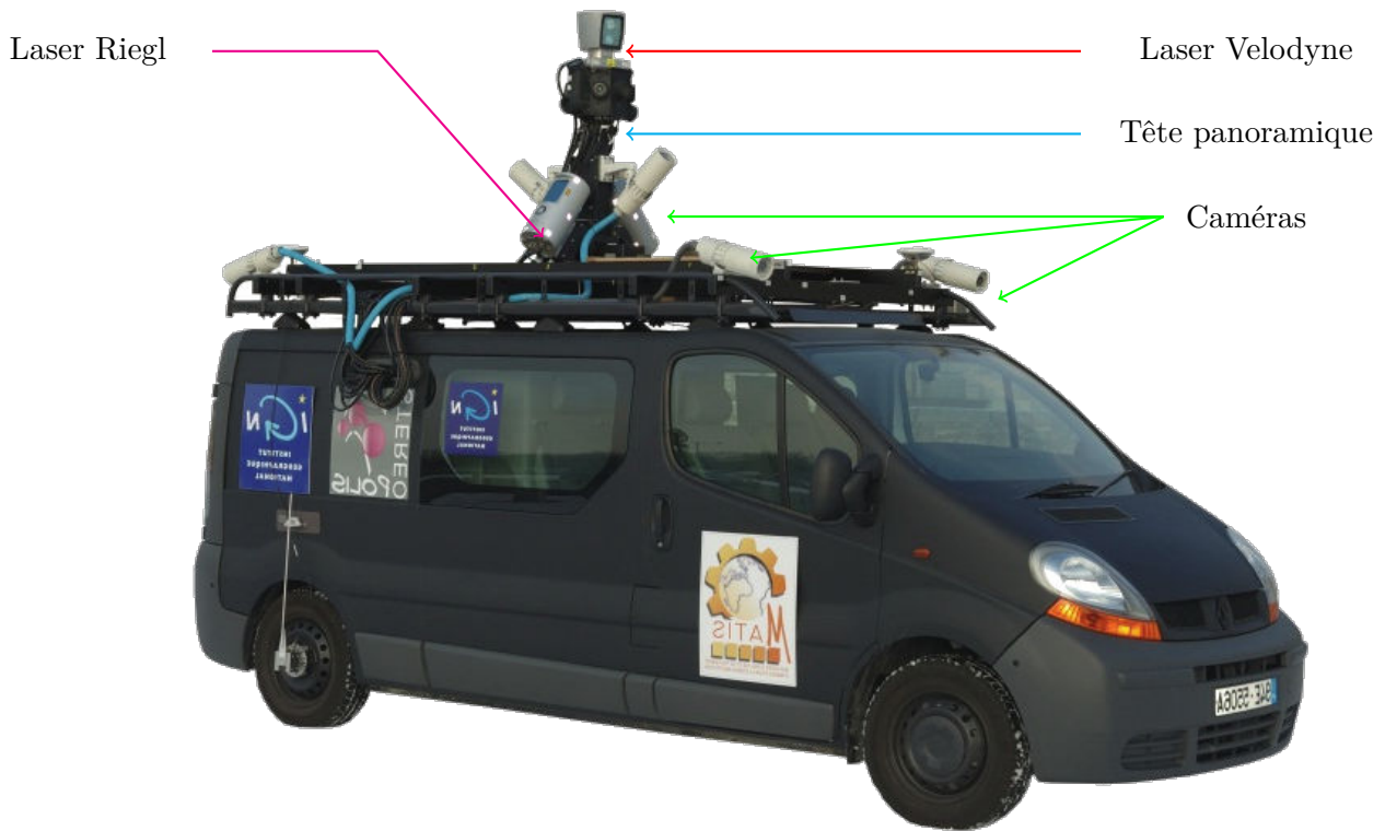
FIGURE 1.1 – Véhicule de cartographie mobile terrestre de l'IGN
