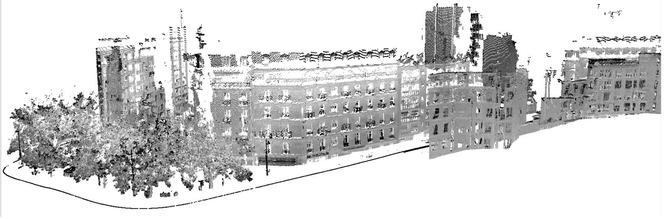
FIGURE 1.3 – Exemple de données acquises par un laser à balayage plan de type RIEGL LMS-Q120i. Le dégradé de gris est fonction de l'intensité retour au capteur. [faible :gris → fort :noir]
