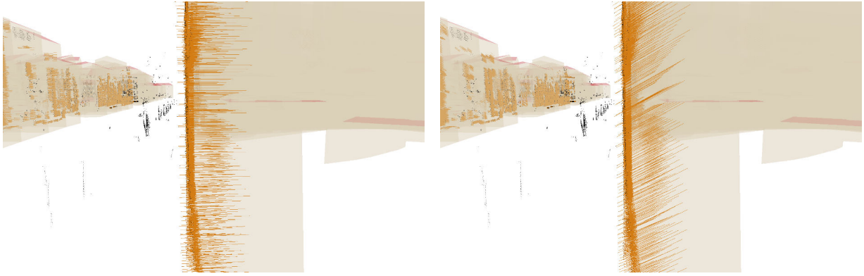
(a) Distance euclidienne entre le point laser considéré et son projeté orthogonal sur la primitive géométrique intersectée.
