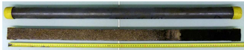
Fig.V.1.4 - Tube de 1 mètre issu d'un carottage au carottier à percussion et demi-section (photographie: J.Goslin)
