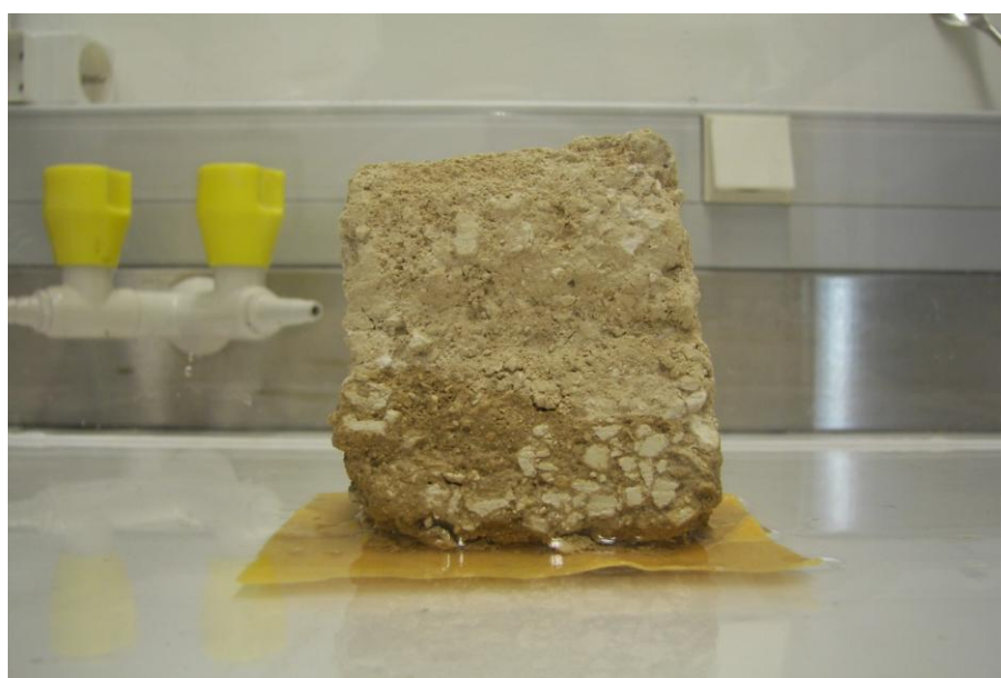
Figure VIII - 2 : Photographie d'un échantillon en cours de test d'imbibition capillaire.
