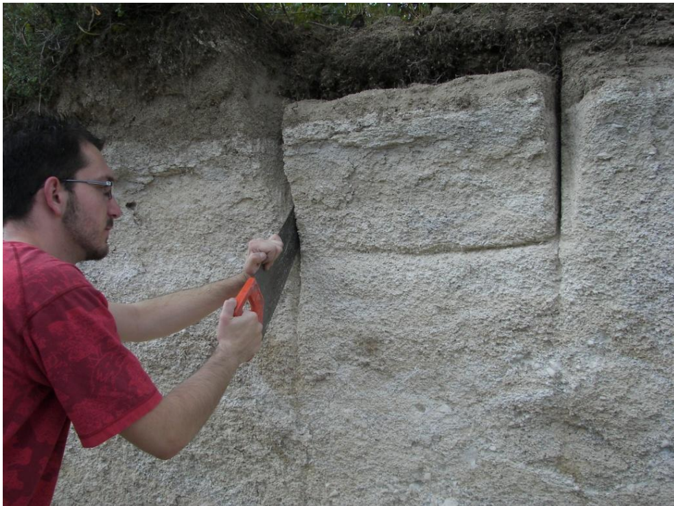
Figure IV - 12 : Prélèvement à la scie des blocs massifs in situ .
