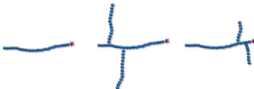
Figure V.8 : Structures des différents macroRAFTs PNAM synthétisés par polymérisation RAFT dans l'eau
