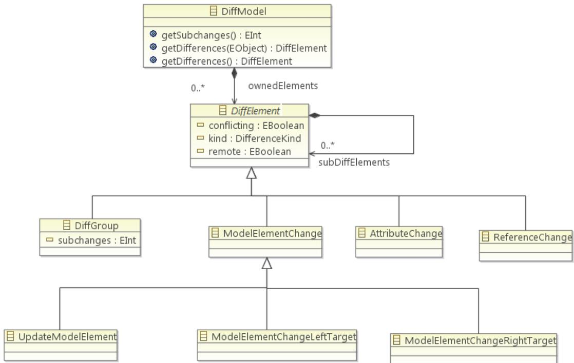
Figure 3.4 – Extrait du méta-modèle de différence d’EMFCompare
