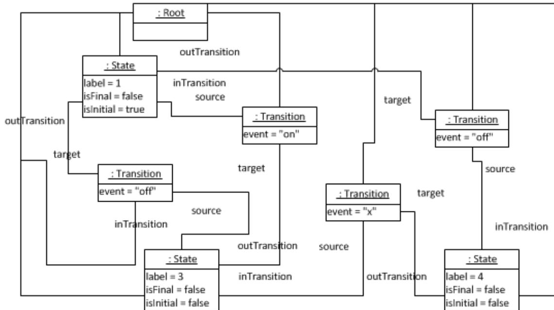
Figure 4.3 – Exemple de modèle de sortie instance du méta-modèle simplifié de machine à état
