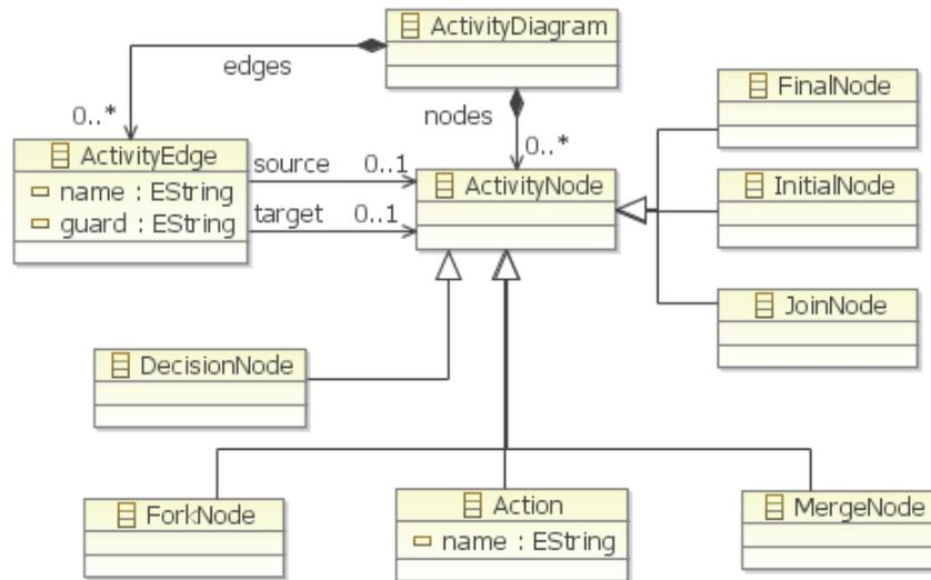
Figure 1.2 – Méta-modèle simplifié du diagramme d’activité UML
