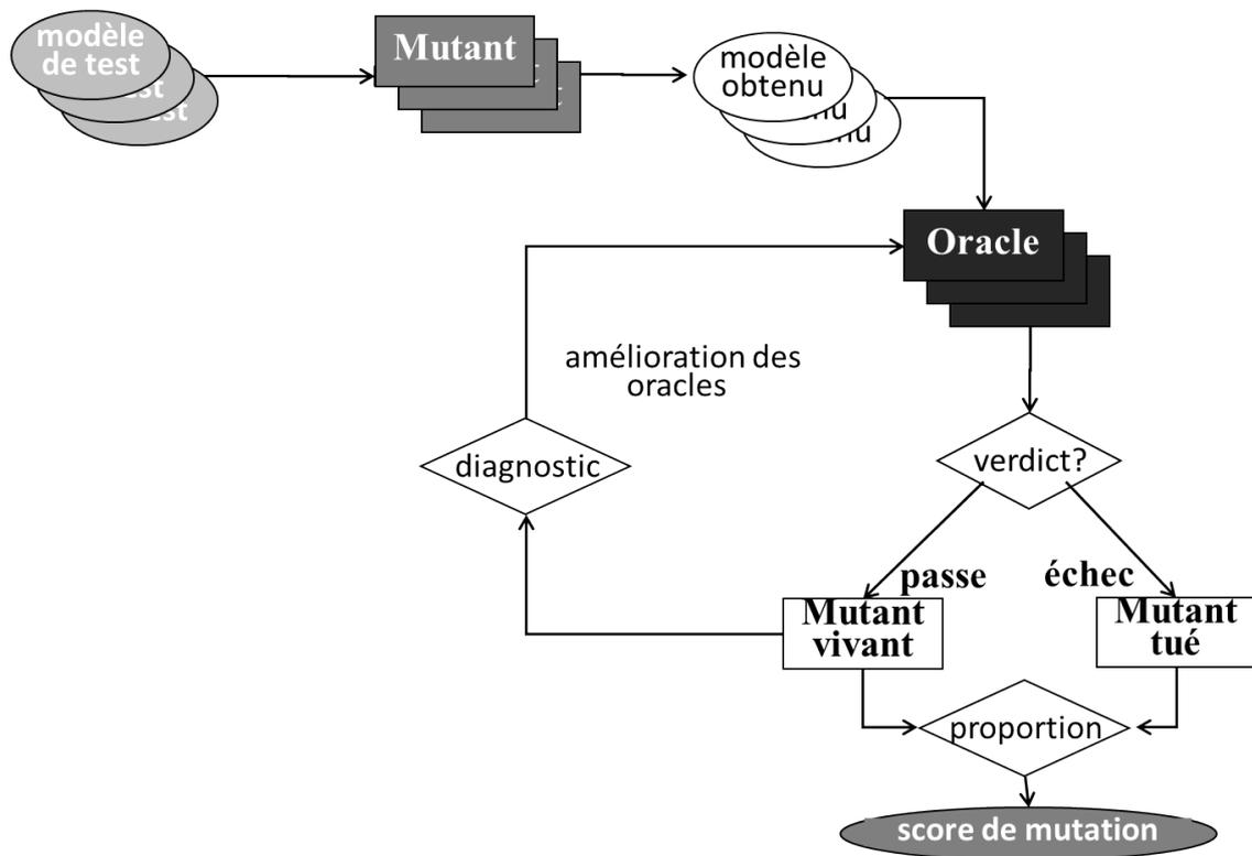
Figure 2.11 – Utilisation de l'analyse de mutation pour qualifier un ensemble d'oracles
