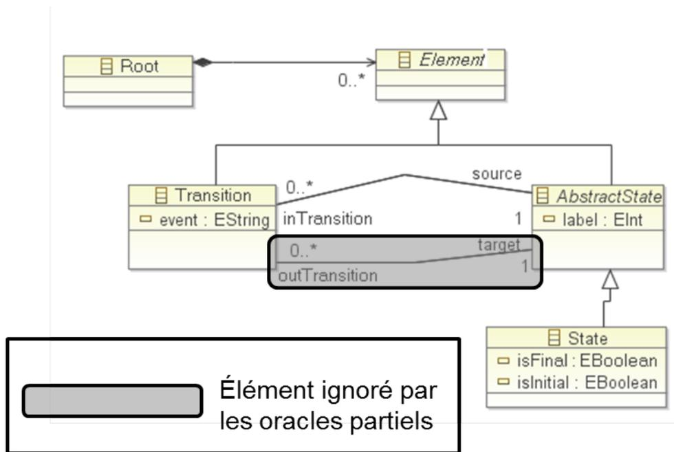
Figure 4.10 – Éléments couverts par l’ensemble d’oracles P3
