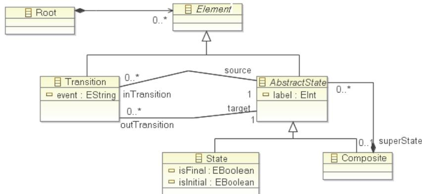
Figure 2.4 – Méta-modèle de la machine à états hiérarchique
