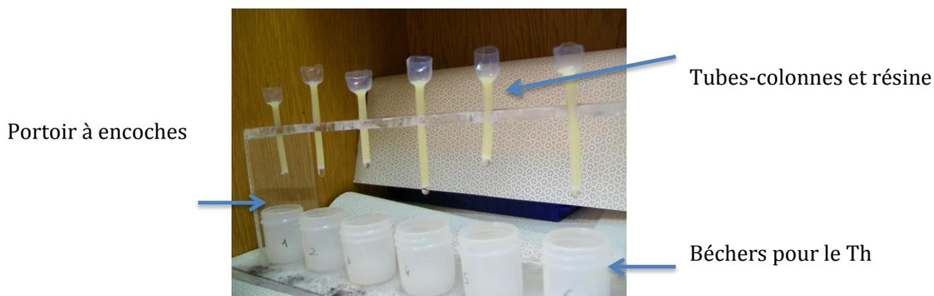
Remplir d'eau M-Q les tubes-colonnes en s'assurant qu'il n'y ait pas de bulles d'air.
