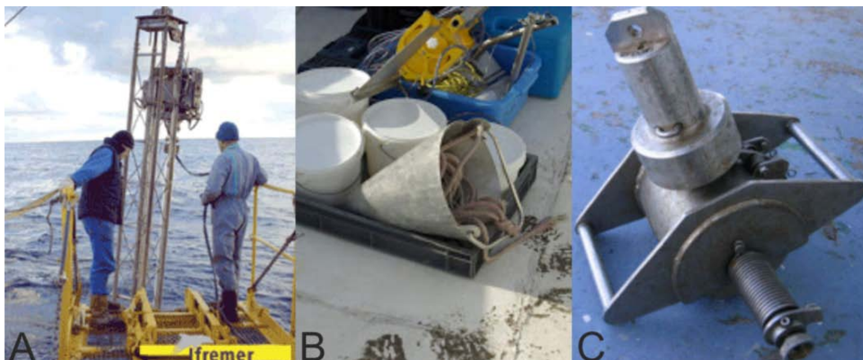
Figure II.4 : Photographie: A) du vibrocarottier. Crédit photo : IFREMER; B) du cône Berthois. Crédit photo : G. Raccasi; C) et de la benne Shipeck. Crédit photo : SHOM.
