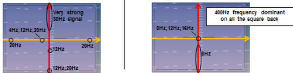
Figure 4.45 - Identification des fréquences dominantes sur le culot pour le cas de jet à 30Hz (à gauche) et à 400Hz (à droite)
