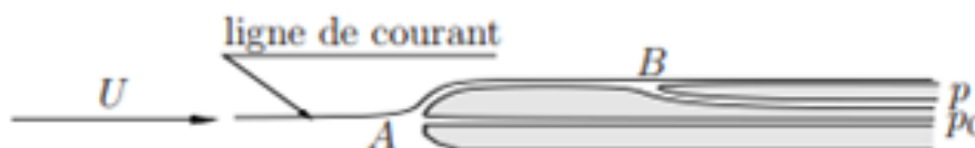
Figure 3.3 - Schéma de principe du tube de Pitot
