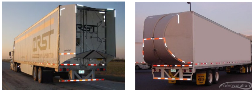
Figure 1.53 – A gauche : Plaques longitudinales utilisées sur un poids lourd. A droite : Appendice amovible "Aerolution product" vendu pour 3,5% de gain de consommation.
