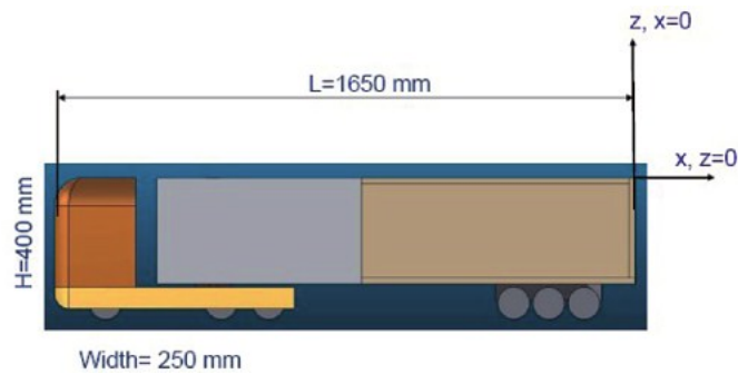
Figure 1.52 - Modèle générique tracteur-remorque utilisé dans l'étude de Nayeri et al. [Nay09]. Ce modèle est à l'échelle 1/10ème des plus gros camions en circulation en Europe
