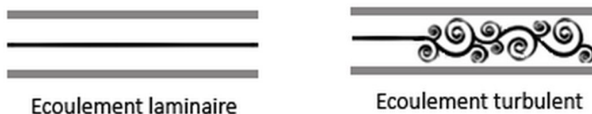
Figure 1.6 - Visualisation schématique d’écoulements laminaire et turbulent dans une canalisation
