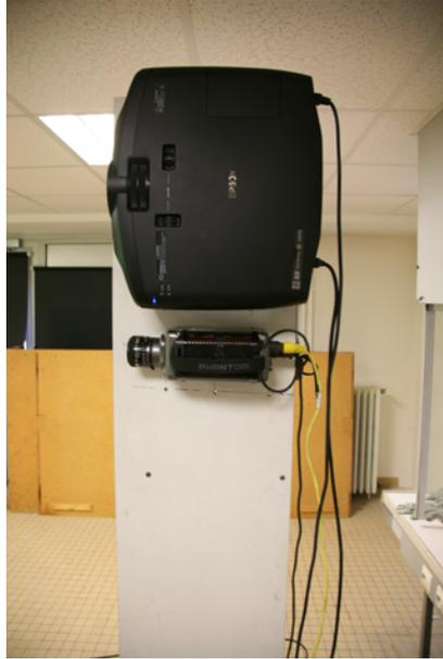
FIGURE 3.18 – Profilométrie par transformée de Fourier : dispositif de mesure. Un vidéoprojecteur EPSON EH-TW9000 et une caméra rapide Phantom V9 sont vissés à un support commun de telle sorte que le capteur de la caméra et celui du vidéoprojecteur soient alignés.
