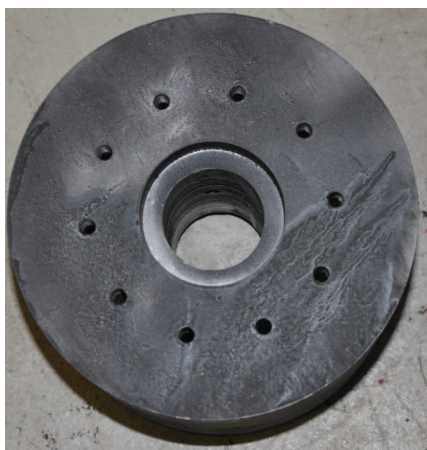
(a) Rotor lisse, à la hauteur intérieure du pôle du rotor encoché.
