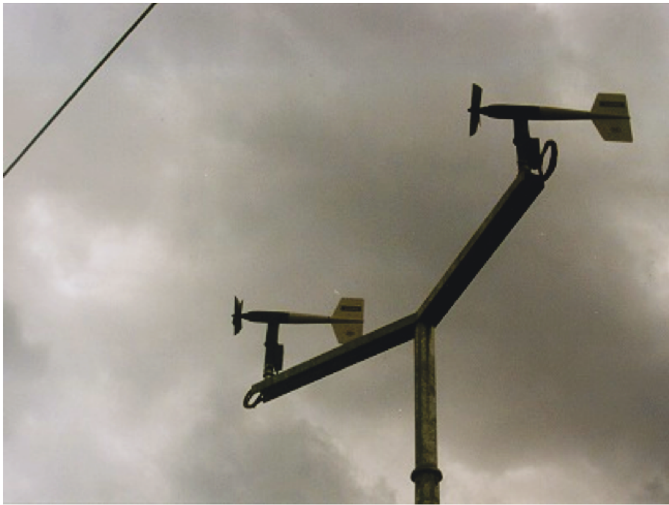
FIGURE 5 – Station anémométrique sur la ligne TGV Méditerranée mesurant la vitesse et la direction du vent - source SNCF -
