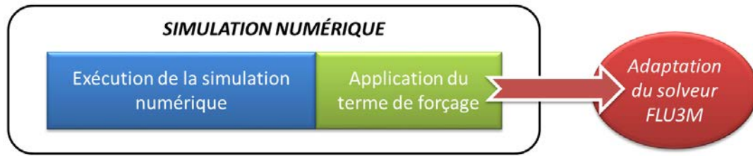
FIGURE 2.16 – Illustration des développements algorithmiques (en rouge) engendrés par l’implantation d’une méthode de modélisation de paroi par forçage (en vert) au sein d’une simulation numérique des écoulements turbulents (en bleu).
