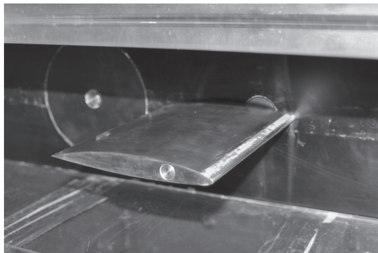
FIGURE 2.5 – Profil NACA 66312 monté dans la section d'essai avec une bande de rugosité au bord d'attaque
