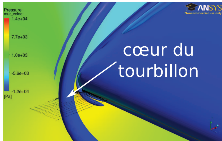
FIGURE 3.18 – Iso-surface du critère Q , vecteurs vitesse dans le plan y = 0,001 m et pression sur le mur de la veine, \alpha = 3^\circ , Re = 7,5 \times 10^5
