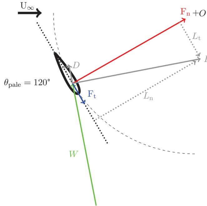
FIGURE 4.6 – Projection des efforts de portance et traînée en efforts tangents et normaux.  $L$  : portance,  $L_t$  : composante tangentielle de la portance,  $L_n$  : composante normale de la portance,  $D$  : traînée,  $F_n$  : effort normal,  $F_t$  : effort tangent.
