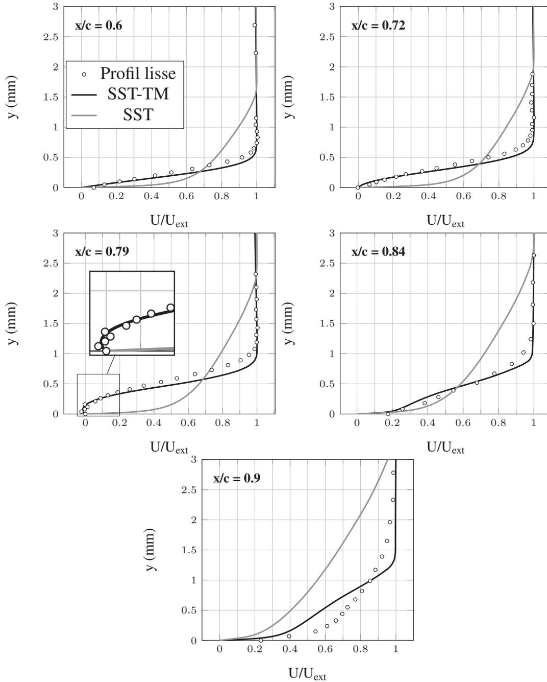
FIGURE 3.13 – Profils de vitesse à 5 emplacements proches et au coeur du bulbe de séparation laminaire,  $\alpha = 2^\circ$ ,  $Re = 7,5 \times 10^5$
