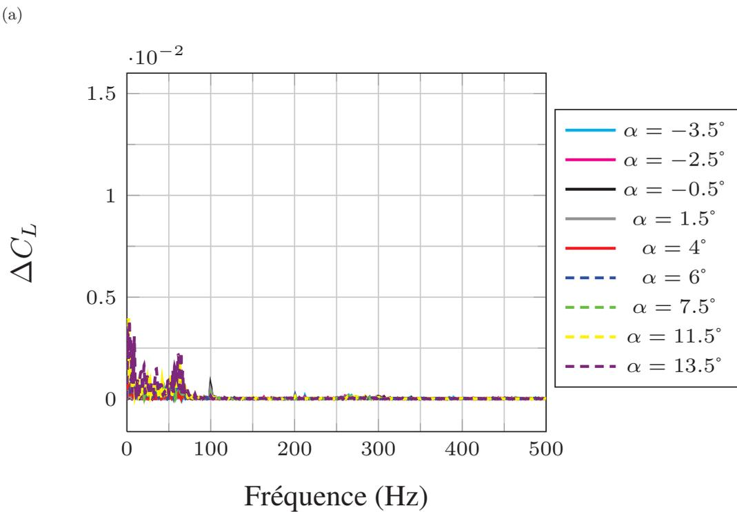
FIGURE 3.3 – FFT des signaux de coefficient de portance sur les profils lisse (a) et rugueux (b),  $Re = 7,5 \times 10^5$
