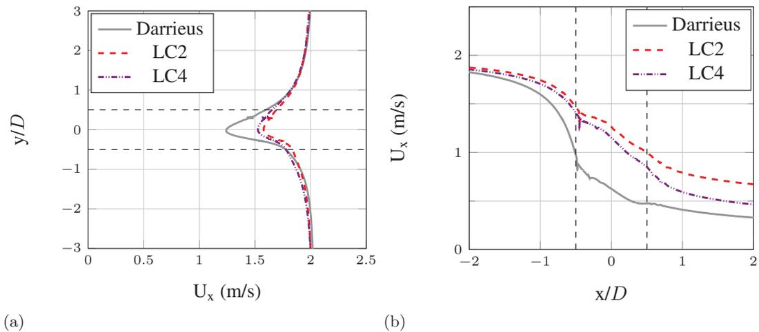
FIGURE 4.41 – Profils de vitesse ( $U_x$ ) en amont de l'hydrolienne ( $x=-1$  m) (a) et sur l'axe  $y = 0m$  (b)
