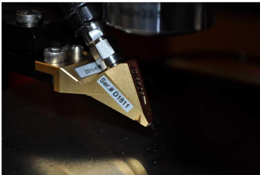
FIGURE A.2 – Pointes radio-fréquence Z-probe Z010-K3N-GS-250 posées sur un HAR IDT. Une seule paire de pointes est utilisée du fait que nous faisons une mesure en réflexion et non en transmission.
