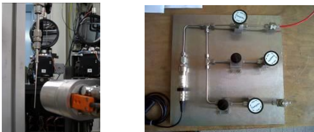
Figure II-9 : Cellule in-situ à gauche et panneau de contrôle en pression d' H_2 à droite.
