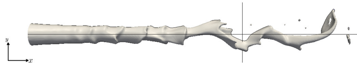
FIGURE 4.16 – Illustration d'une ligne de mesure transverse, mesurant les profils instantanés de fonction indicatrice de phase \chi(y, t)_x . Ces profils permettent de connaître le diamètre du jet et la position du centre moyen du jet par rapport à l'axe.
