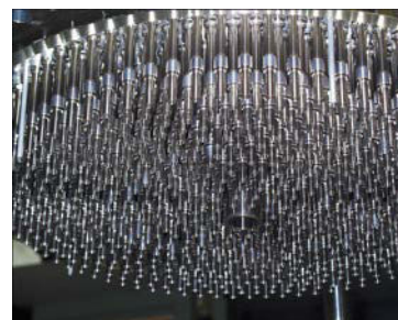
FIGURE 2 – A gauche : vue schématique du Moteur Vinci (Snecma), dont il est prévu qu'il équipe la fusée Ariane 6. A droite : assemblage des 566 injecteurs coaxiaux du moteur Vulcain 2 (EADS Astrium).
