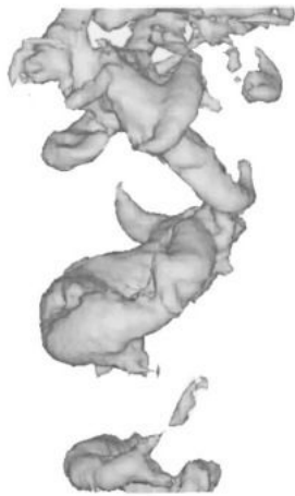
(a) Illustration du phénomène d'appariement de structures tourbillonnaires dans un jet rond monophasique, par la visualisation d'iso-surface de basse pression. D'après [19].
