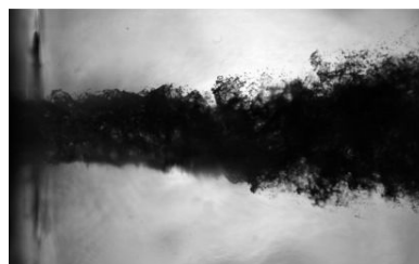
FIGURE 3 – A gauche : représentation en coupe d'un injecteur coaxial. A droite : jet d'oxygène liquide (LOX) cisailé par une couronne de dihydrogène gazeux ( H_2 ) (d'après Murrone et al. [97]).
