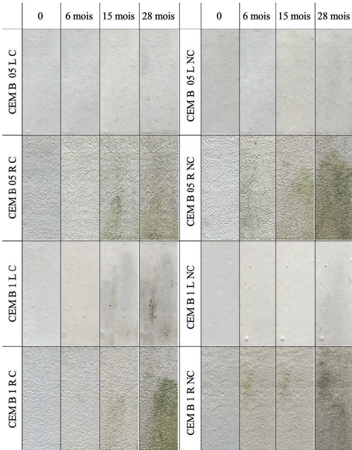
Figure IV- 7 : Recouvrement des éprouvettes de CEM B
