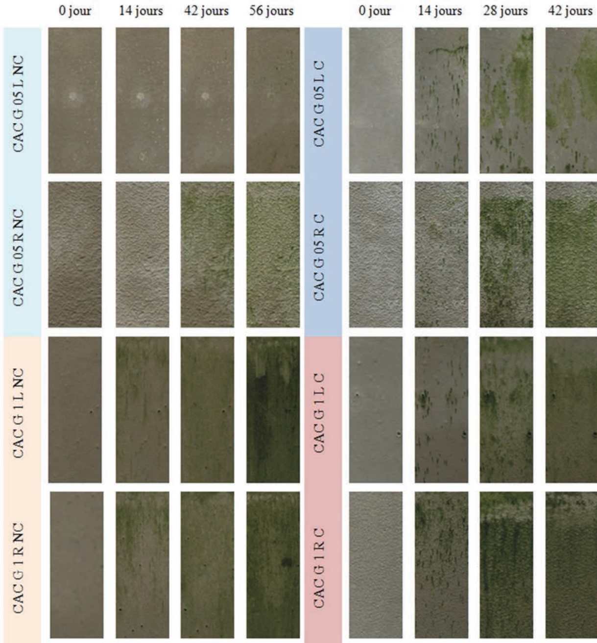
Figure III- 23 : Evolution des éprouvettes de CAC G durant leur biodétérioration _ Observation visuelle
