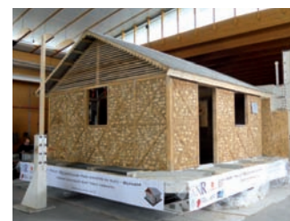
Fig.24: a) Bangladesh, maquettes d'habitation pour la discussion avec les communautés (crédits: Caritas Bangladesh) ; b) Népal, démonstration sur table vibrante mobile des bonnes pratiques parasismiques (crédits: NSET) ; c) Haïti, essai sur table vibrante pour validation scientifique, projet RepairH
