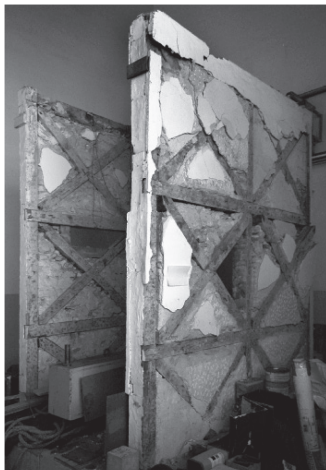
Essais expérimentaux de la capacité sismique (dans Langenbach 2008)
