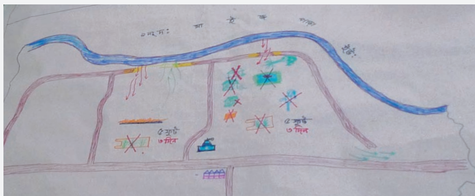
Fig.41: Carte des risques: zones et structures affectées, points de rupture des digues et flux de l'eau lors d'une inondation passée (Mymensingh, Dinajpur)
