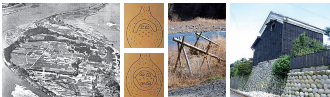
Fig.80: a) digue circulaire waju (source: SHAW, TAKEUCHI, 2007) ; b et c) : évolution de la forme des digues waju (source: HIRUNSALEE, JANMAIMOO, YUSUKE, et al. 2009) d) : structures hijiri-ushi mises en place le long des berges des rivières (source: http://www.panoramio.com ) ; e) : surélévation des habitats (source: www.city.ogaki.lg.jp.e.ab.hp.transer.com )
