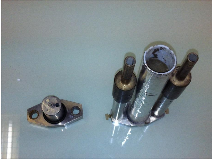
Figure 45 : Capuchon supérieur et partie inférieure du moule remplie
