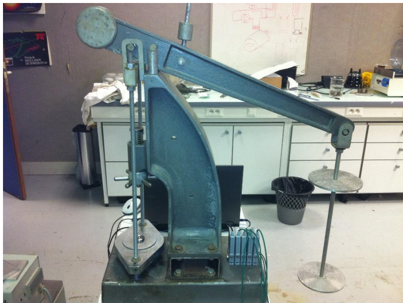
Figure 43 : Bâti de fluage déchargé
