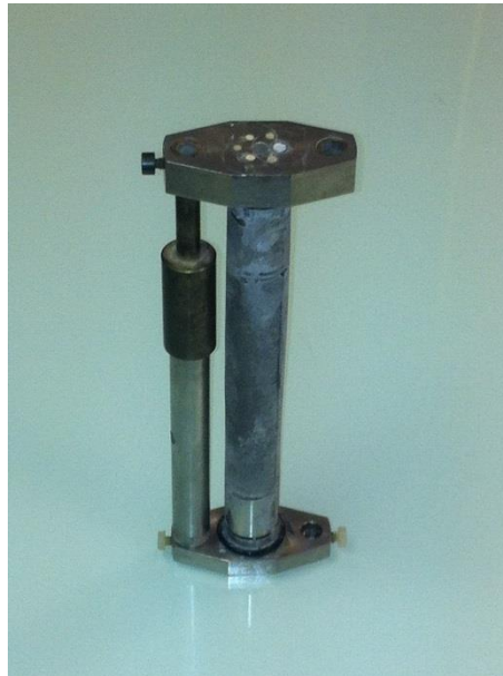
Figure 44 : Epreuve de ciment avant chargement.
