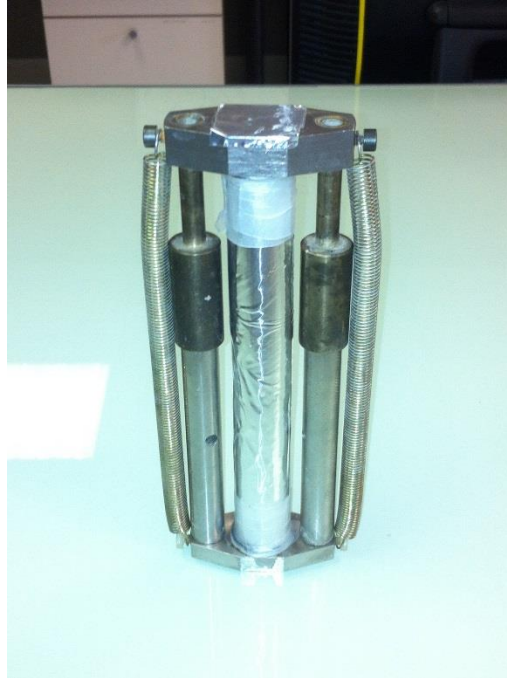
Figure 46 : Eprouvette dans son moule assemblé
