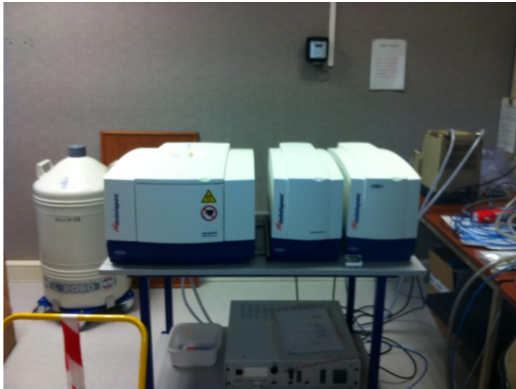
Figure 34 : Appareil de suivi de relaxométrie Minispec
