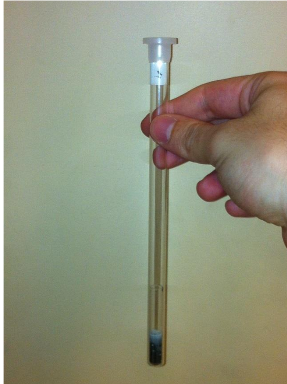
Figure 35 : Echantillon de Minispec dans un insert.
