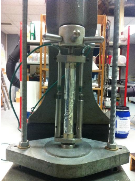
Figure 51 : Photo et schéma d'un échantillon en place avant mise sous contrainte
