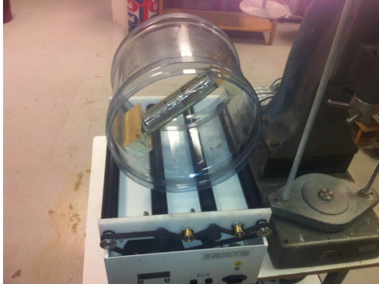
Figure 47 : Agitateur rotatif permettant de s'affranchir de la sédimentation.
