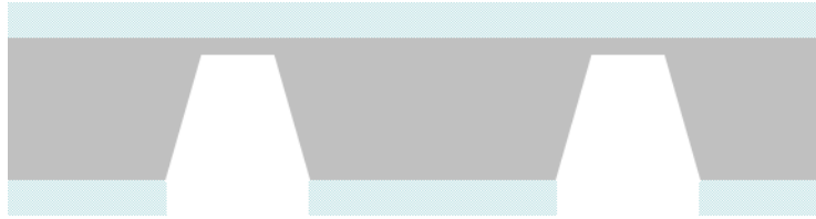
Figure 4.14 : Ouverture et gravure du silicium par la face arrière.
