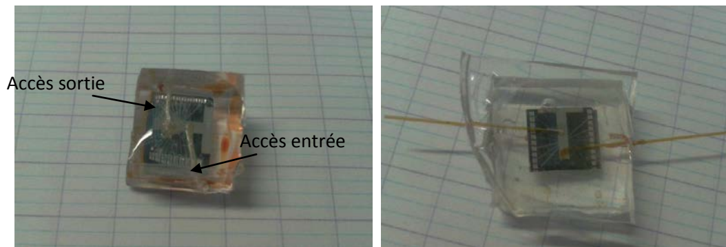
Figure 3.49: Accès inlet/outlet réalisés par coulage du PDMS.
