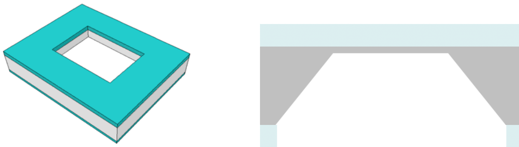
Figure 4.38: Première étape de gravure du silicium (voie humide).
