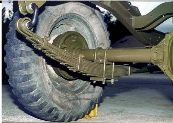
Figure 1.2. Suspension d'essieu à ressort à lames avec dissipation par frottement sec entre les lames [Bellet et al., 2010]
