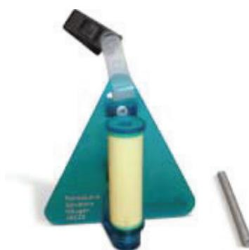
**Figure 1.12 exemple de tube passif (tube radiello)**
