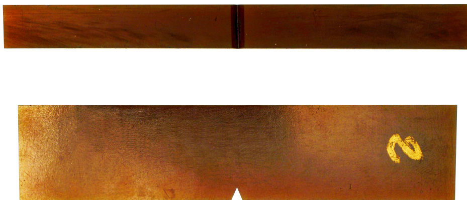
FIGURE II.7 – Éprouvette Single Edge Notched Beam fabriquée pour des essais de flexion 3-points quasi-statiques et dynamiques selon les dimensions spécifiées dans la FIGURE II.1.
