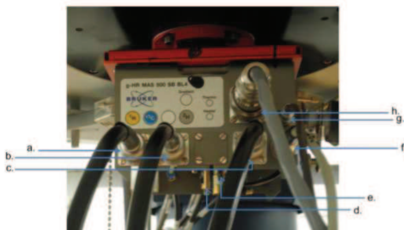
Figure 8. Partie connectique de la sonde HRMAS, (a) canal proton ^1\text{H} , (b) canal carbone ^{13}\text{C} , (c) canal deutérium ^2\text{H} , (d) réglage de l'angle magique, (e) réglage des antennes RF, (f) chauffage, (g) mesure de la température, (h) gradient (d'après Benhamed, 2012)
