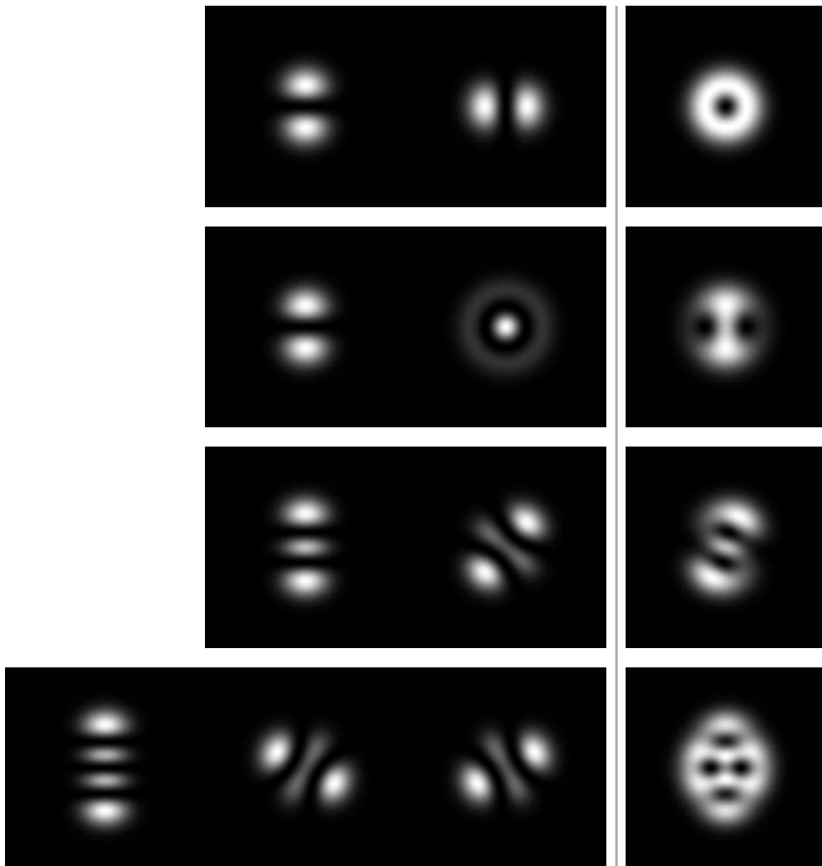
FIGURE 3.21 – Reconstitutions des profils d'intensité observés sur la figure 3.19 obtenues en sommant les profils d'intensité de différents modes usuels.
