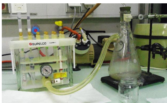
Figure 23. Montage SPE à l'Institut de Chimie Organique et Analytique d'Orléans
