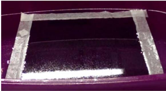
(a) Après l'application du solvant *B*, le film se dilue. L'impression reste en place sur la surface de l'eau.
