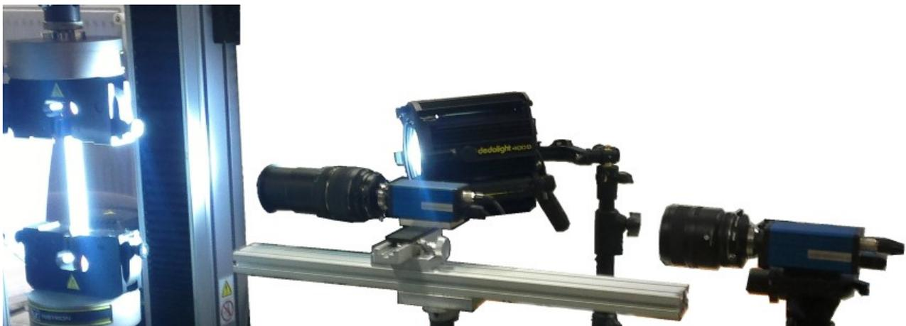
FIGURE 4.3 – Montage de l'essai multi-échelles avec platine de translation
