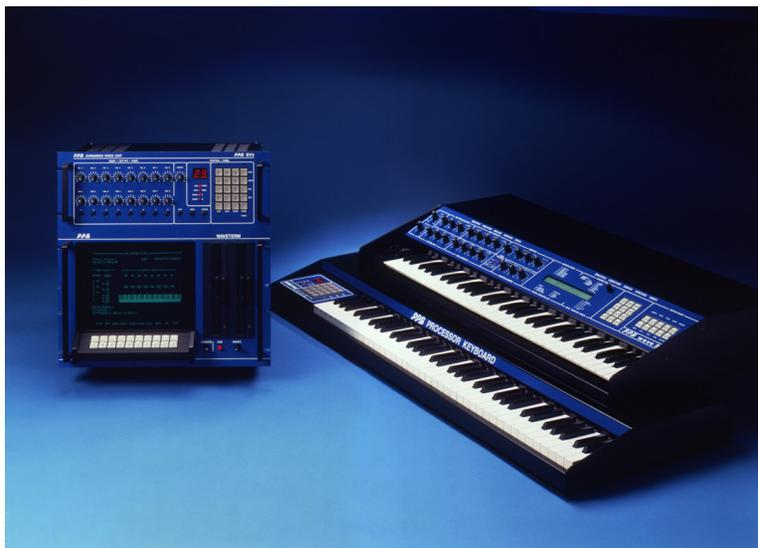
FIGURE 2.17 – Photographie d'un système PPG *Wave 2* complet (1981) incluant le moniteur *Waveterm* de visualisation de tables d'ondes.
