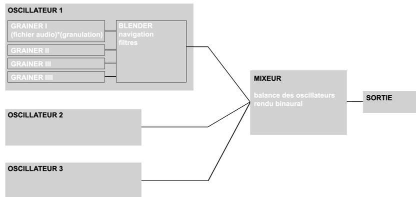
FIGURE 4.1 – Architecture simplifiée du prototype de synthétiseur : de gauche à droite, les oscillateurs composés de quatre *Grainers* dont le mélange et le filtrage sont contrôlés par le *Blender*, les oscillateurs sont ensuite mélangés dans le Mixeur principal.
