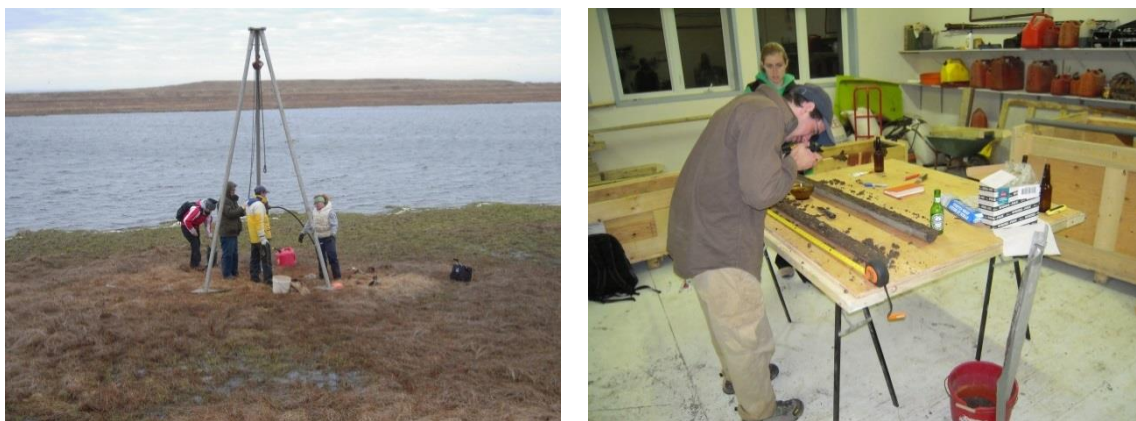
Figure III-5 : Prélèvement (à gauche) et ouverture (à droite) des carottes sédimentaires.
