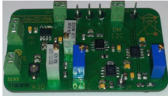
Figure 3.17: Le circuit câblé de la détection synchrone discrète qui comprend également le circuit à pont de Wheatstone classique à polarisation constante.
