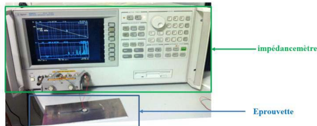
Figure 3.2: Principe de fonctionnement du banc de mesure pour la détection de défaut par mesure d'impédance électromécanique
