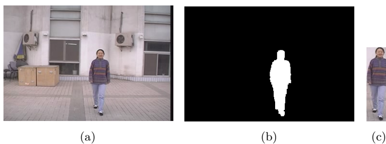
FIGURE 4.12 – Détection de la ROI : (a) image originale, (b) silhouette binaire, (c) ROI.
