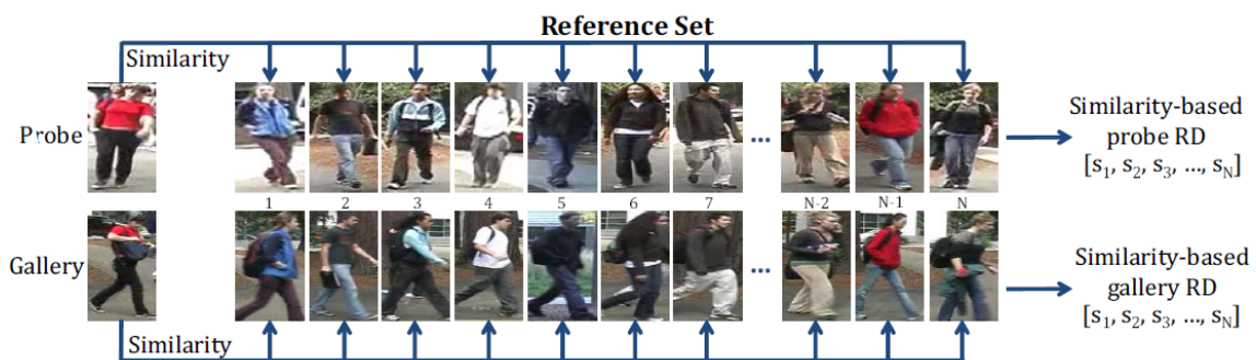
FIGURE 2.16 – La représentation d'une image de la base de test est générée par le calcul des similarités entre cette image et les images d'apprentissages prises par la même caméra (An et al. , 2013).
