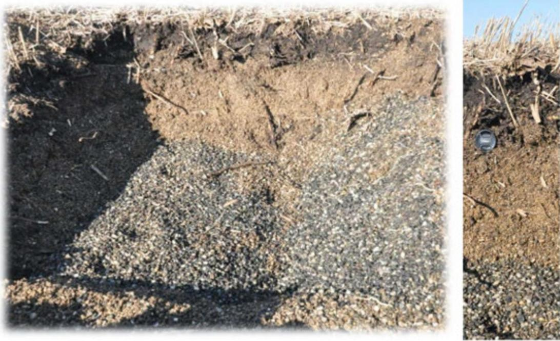
[Figure II.22] Vues en coupe du 1<sup>er</sup> étage du FPR après le prélèvement des matériaux.
