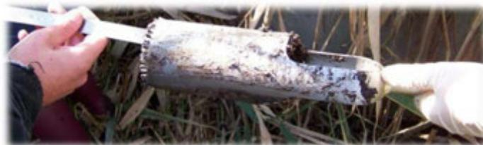
**[Figure II.19] Vues de la tarière utilisée pour le carottage des boues du 1<sup>er</sup> étage du FPR.**
