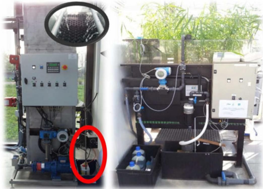
**[Figure II.25] Vue générale des installations : le pilote lit-bactérien (à gauche) avec sa cuve de mélange, la pompe doseuse pour l'injection du  $\text{FeCl}_3$  (entourée en rouge), et le 1<sup>er</sup> étage de filtre planté de roseaux (à droite)**
