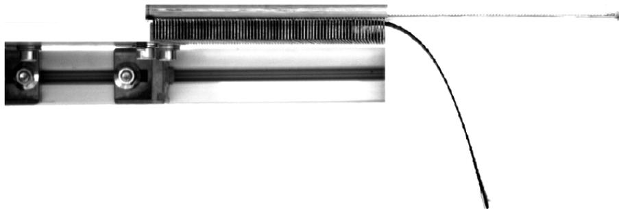
**Figure 1.34** – Dispositif de flexion de Bilbao [BIL 10]
