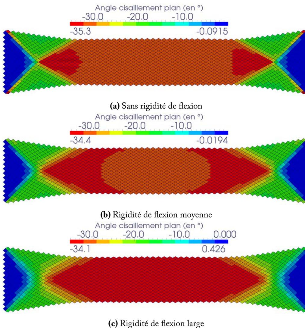
Figure 5.31 – Zones de cisaillement en fonction de la rigidité de flexion
