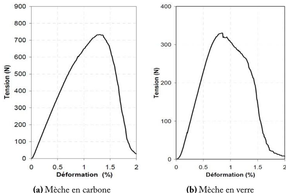
**Figure 1.13** – Comportement en tension de mèches [DUM 03]
