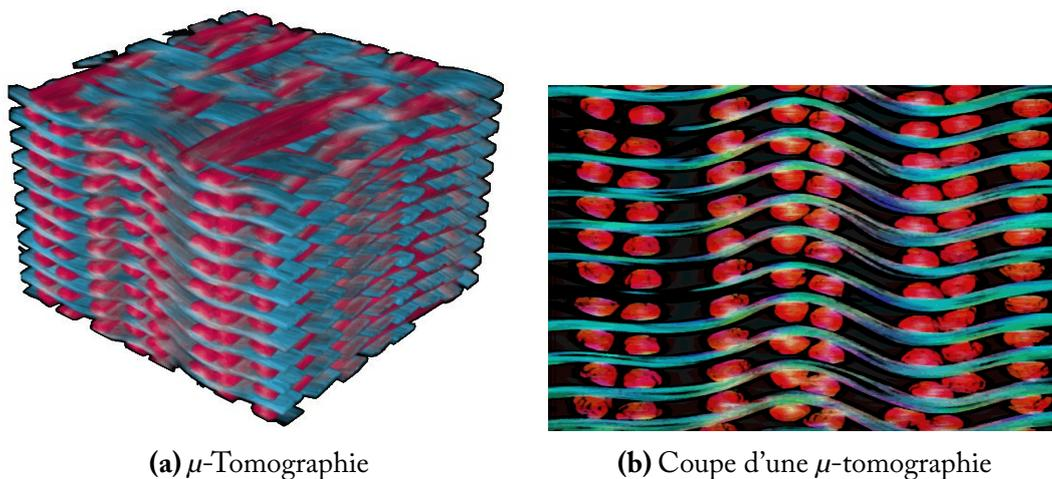
Figure 1.5 – Structure des tissés interlock
