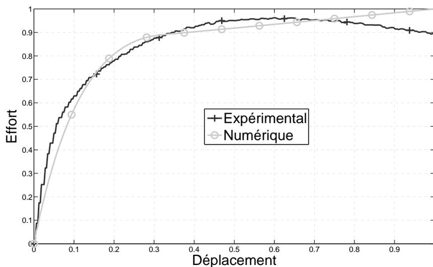
Figure 6.8 – Identification numérique normalisée en cisaillement plan du comportement
