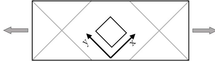
Figure 3.7 – Repère local pour des éléments orientés à 45°
