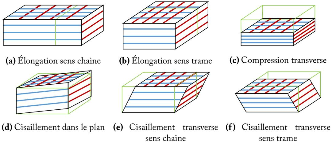
**Figure 2.17** – Modes de déformation des renforts interlocks
