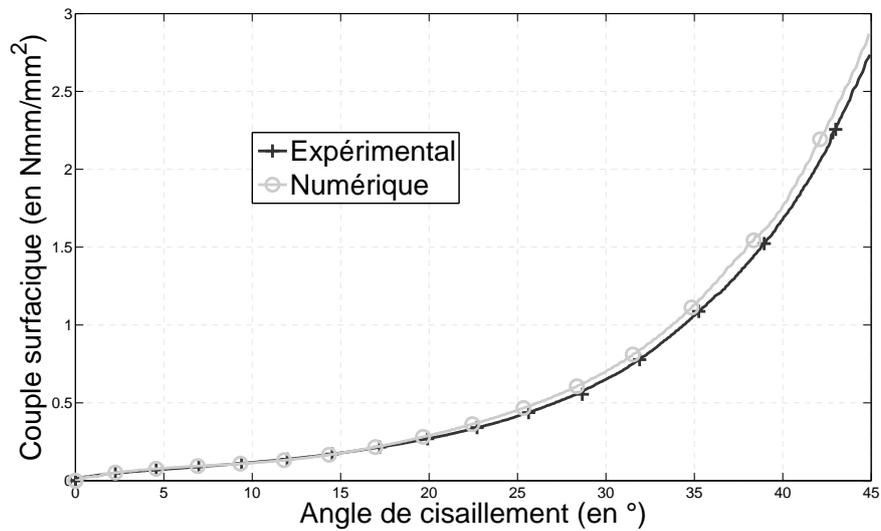
**Figure 2.23** – Identification numérique en cisaillement plan du comportement
