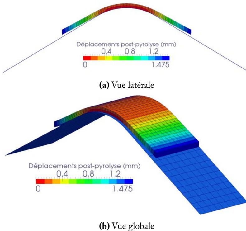
**Figure 6.11** – Simulation d'une cornière au stade pyrolysé
