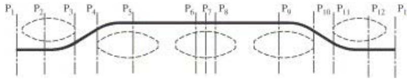
**Figure 2.5** – Plans définissant les points de contrôle pour un sergé 3x2 [HIV 05]
