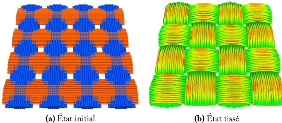
**Figure 2.2** – Modélisation du VER d'un renfort après tissage [DUR 10]
