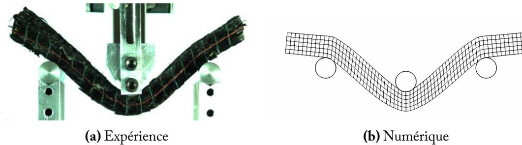
**Figure 4.9** – Essai de flexion trois points sur tissé épais avec méthode F-Bar - flèche de 40mm
