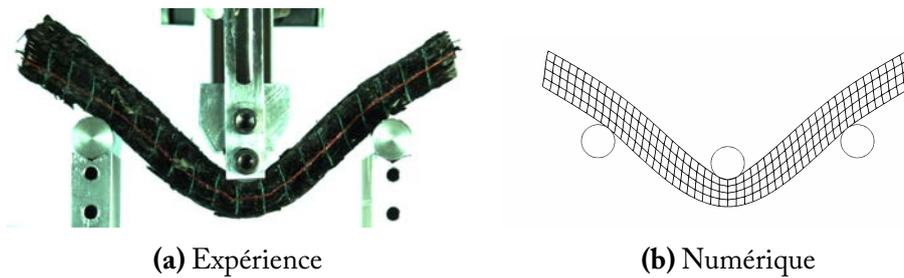
**Figure 5.24** – Essai de flexion trois points sur tissu épais avec formulation en flexion - flèche de 40mm
