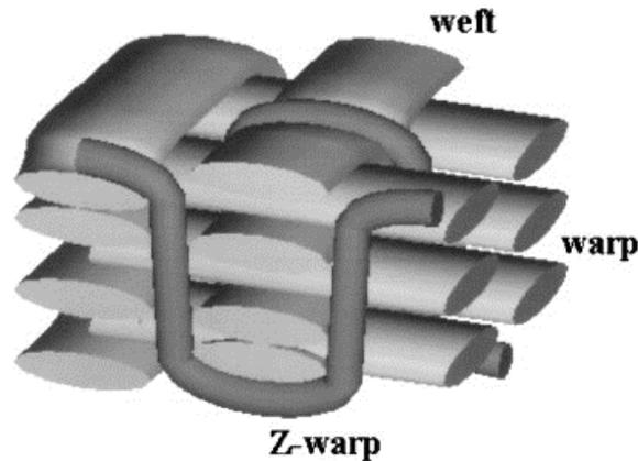
**Figure 2.4** – Génération d’une structure 3D d’un renfort en carbone [LOM 00]
