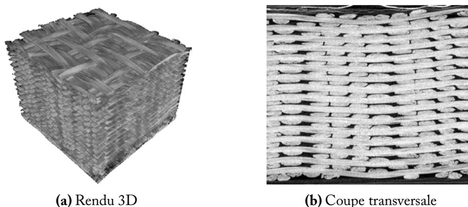
**Figure 5.13** – Exemple de structure de renfort interlock 2.5D
