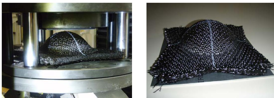
**Figure 5.9** – Préforme en fin d'emboutissage hémisphérique
