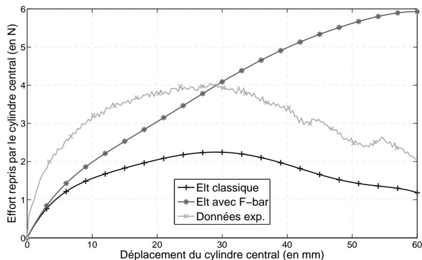
**Figure 4.11** – Effort repris par le cylindre central en fonction de la flèche imposée avec la méthode F-bar par rapport à un élément classique sens chaîne
