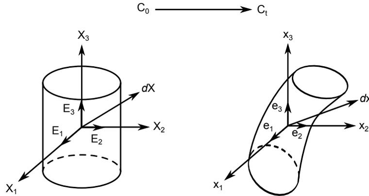
**Figure 2.15** – Configuration initiale  $C_0$  et configuration actuelle déformée  $C(t)$
