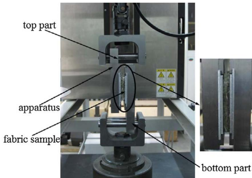
**Figure 1.32** – Dispositif de cisaillement transverse [ZHA 13]
