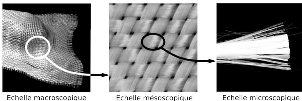
**Figure 1.10** – Les différentes échelles d'un renfort tissé
