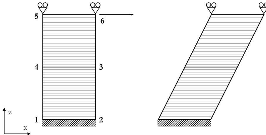
**Figure 4.8** – Cisaillement simple de deux éléments dans le plan  $(x, z)$  avec la méthode F-bar
