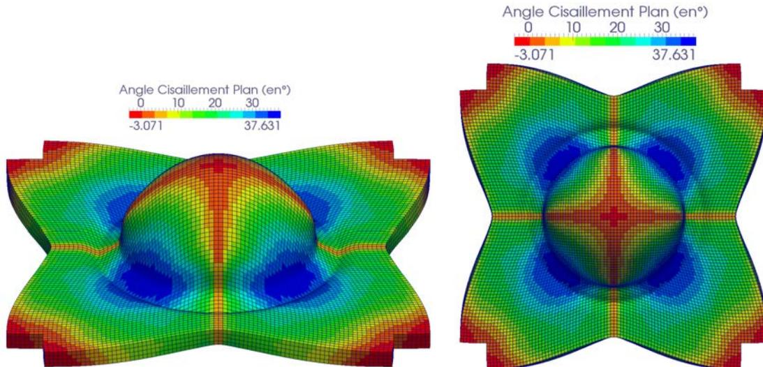
**Figure 5.34** – Simulation d'un emboutissage hémisphérique avec des résistances à la courbure
