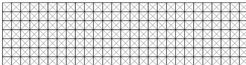
**Figure 3.34** – Maillage à  $90^\circ$  de l'éprouvette de traction de biais avec l'élément semi-discret
