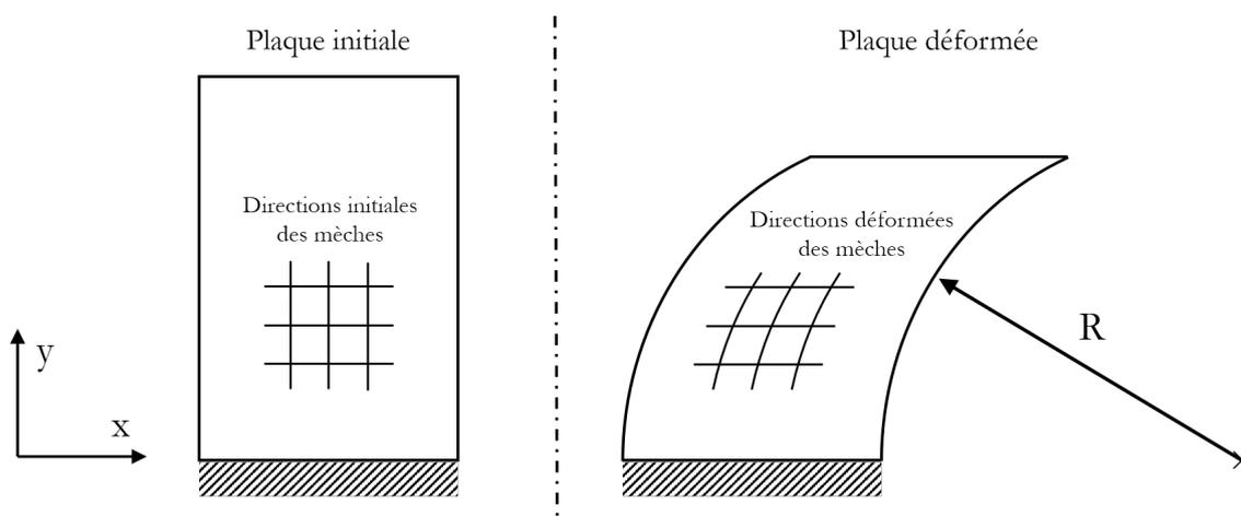
**Figure 3.19** – Représentation schématique de la dépose sur cercle
