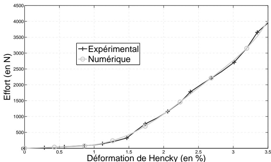
**Figure 2.19** – Identification numérique en tension du comportement
