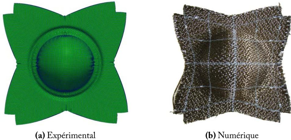
**Figure 5.10** – Vues de dessus de l'éprouvette emboutie par le poinçon hémisphérique
