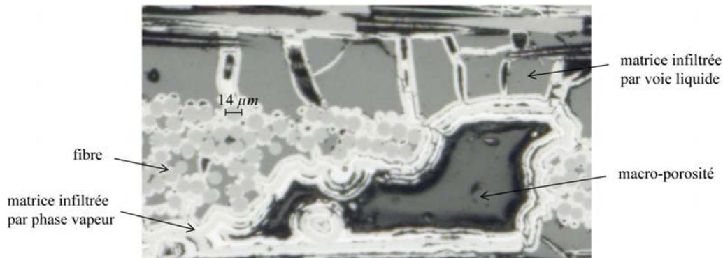
**Figure 1.9** – Matrice inter-fils en bord de porosité : en blanc la matrice infiltrée par phase vapeur (CVI), en gris foncé la matrice infiltrée par voie liquide (CVL) [GRI 13]
