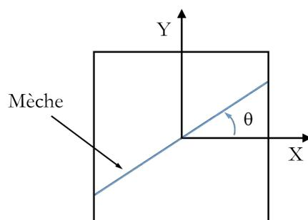
**Figure 3.11** – Orientation d'une mèche dans l'élément fini à tester
