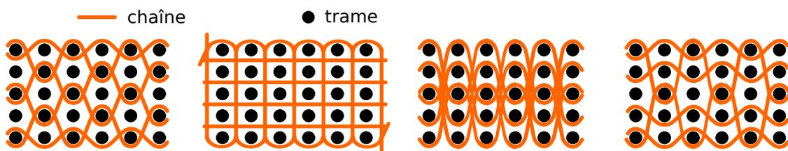
**Figure 1.2** – Armures de renforts fibreux épais [GU 02]
