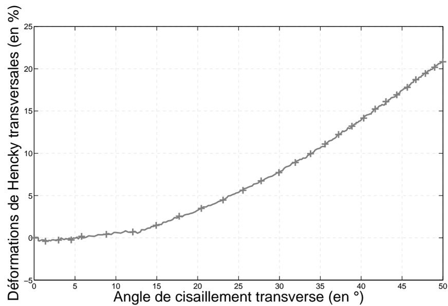
**Figure B.2** – Exemple de déformations transversales en fonction de l'angle de cisaillement transverse sens chaîne pour un interlock
