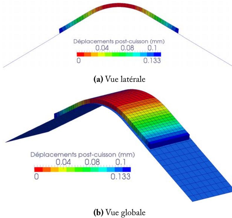
**Figure 6.10** – Simulation d'une polymérisation de cornière
