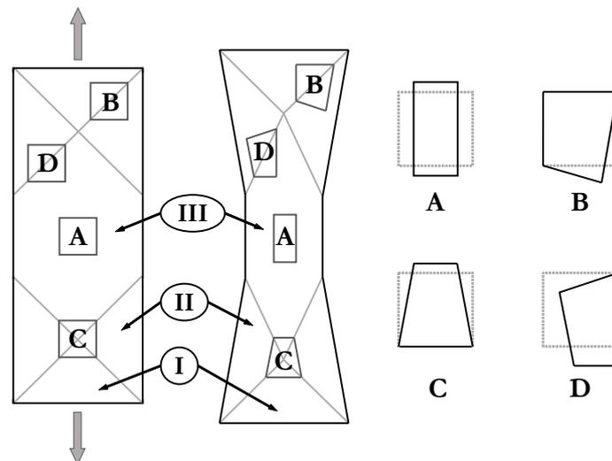
**Figure 3.3** – Modes de déformation pour certaines zones d'un essai de traction de biais [YU 06]
