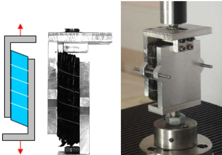
**Figure 1.29** – Essai de cisaillement transverse sur Interlock [ORL 12]
