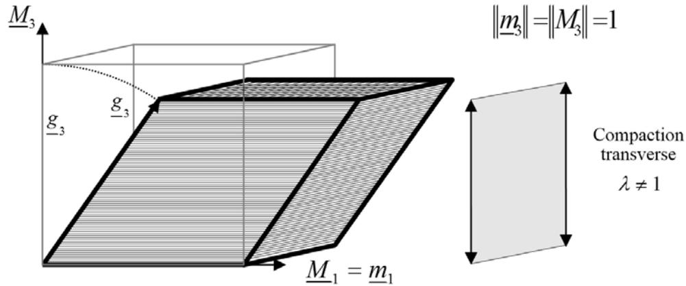
**Figure A.1** – Compression d'un tissu en cisaillement transverse pur
