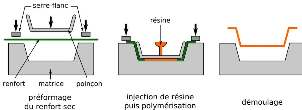
**Figure 1.7** – Illustration du processus RTM [BOI 04]
