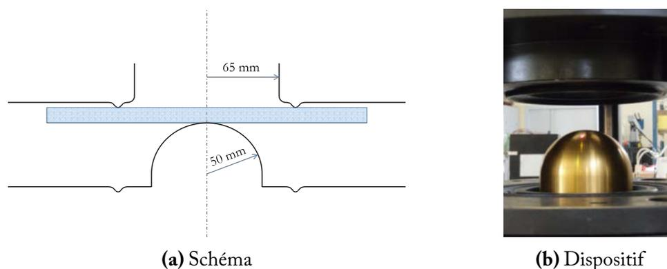
**Figure 5.8** – Caractéristiques du montage d'emboutissage hémisphérique
