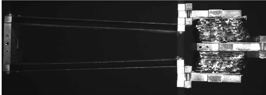
**Figure 1.31** – Cisaillement transverse sur tissu interlock
