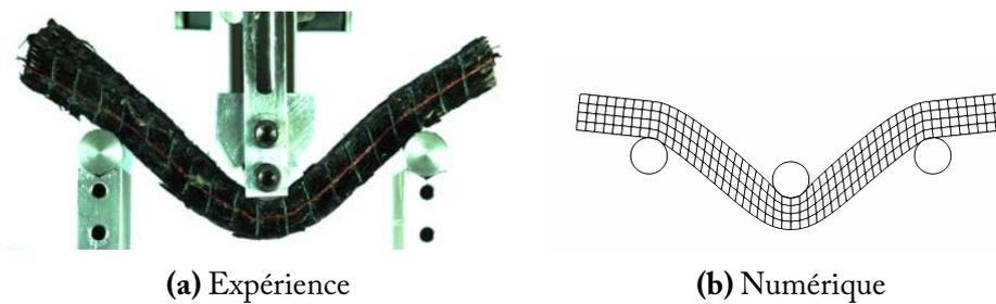
**Figure 5.3** – Essai de flexion trois points sur tissé épais - flèche de 40mm
