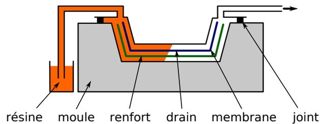
**Figure 1.6** – Illustration du processus d'infusion sous vide
