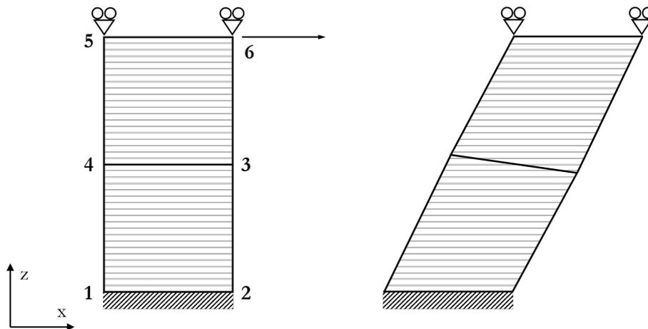
**Figure 4.5** – Cisaillement simple de deux éléments dans le plan  $(x, z)$
