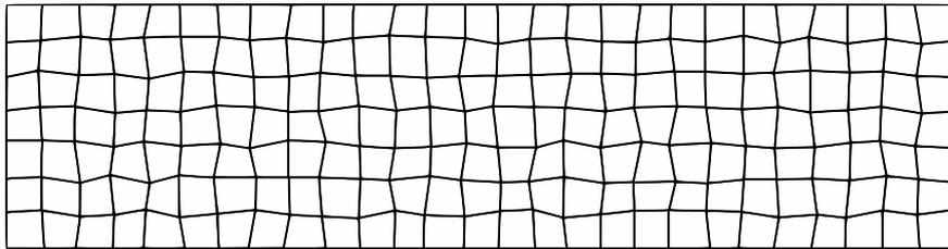
**Figure 3.18** – Maillage à 90° plus grossier et distordu de l'éprouvette de traction de biais
