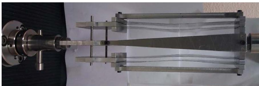
**Figure 1.30** – Nouveau dispositif de cisaillement transverse
