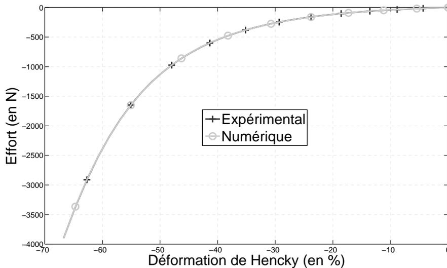
**Figure 2.22** – Identification numérique en compression transverse du comportement
