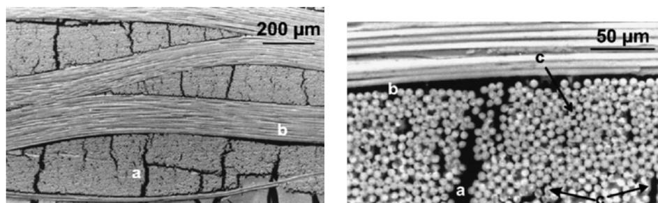
**Figure 6.2** – Microscopie MEB d'un composite C/C pyrolysé à 880 °C [SCH 07]
