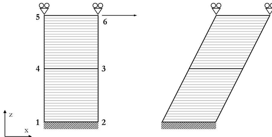
**Figure 4.13** – Cisaillement simple de deux éléments dans le plan  $(x, z)$  avec la méthode de stabilisation hourglass
