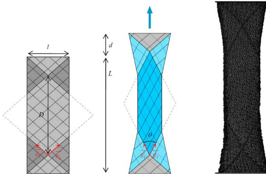
Figure 1.27 – Cinématique d'une éprouvette de bias extension test
