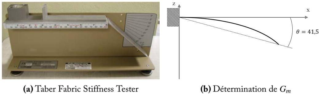
**Figure 1.33** – Identification de la rigidité des mèches
