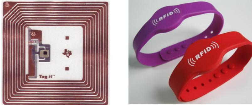
Figure 1.15: Puce et bracelets RFID. L'antenne (sous forme de spirale) occupe la majeure partie de la surface de la puce.
