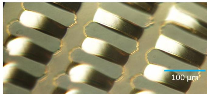
**Figure 6.22: Micro-bilames en Ti-Au.**
