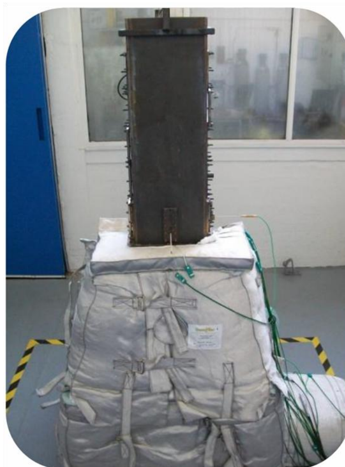
Fig. A.4 : Photographie illustrant l'isolation de la partie basse du foyer.
