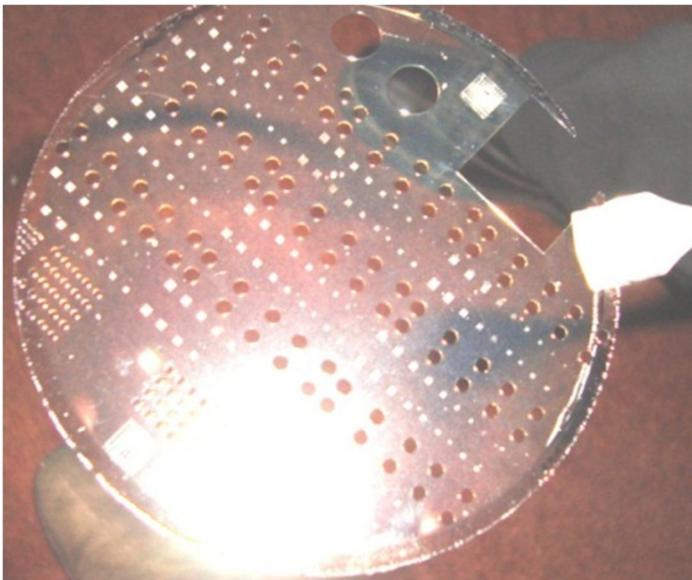
Fig. 2.6: Photo montrant un réseau de trous de diamètres 10 $\mu\text{m}$ , 20 $\mu\text{m}$ , autres dimensions ..., réalisés dans un film SU8 d'épaisseur 500 $\mu\text{m}$ .
