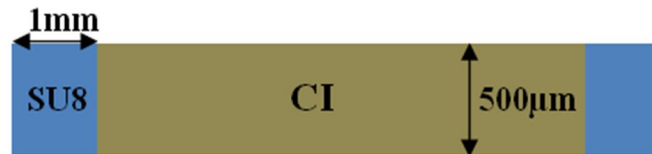
Fig.4.28 : Vue en coupe d'une puce Silicium entourée par une résine époxy 1 mm de SU8
