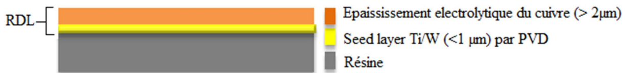
Fig.2.29 : Illustration de la constitution de la couche métallique RDL
