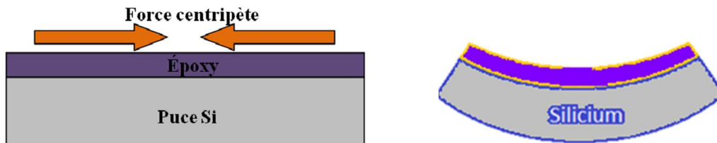
Fig. 3.4 : Exemple de l'effet de la contrainte de polymérisation dans une structure d'assemblage hétérogène : polymère/silicium
