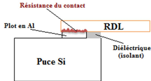
Fig.2.31 : Illustration schématique de la prise de contact avec le plot d'une puce.
