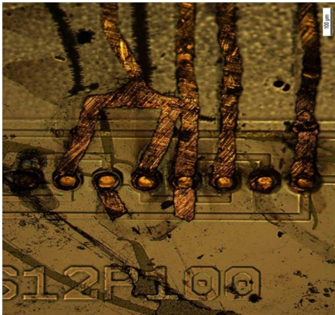
Fig.2.35 : Photo montrant l'endommagement des pistes RDL non protégées pendant l'amincissement
