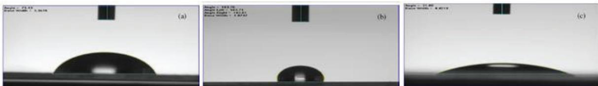
Figure I - 33 : Photographies des angles de contact à l'eau de (a) : PC seul, (b) : PC avec un dépôt fait à partir de TMS et (c) : PC avec un dépôt fait à partir d'un mélange TMS/ $\text{O}_2$  (ratio=0,67) <sup>130</sup>
