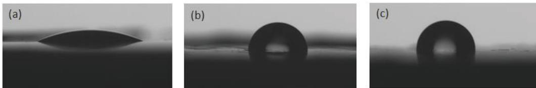
Figure IV - 26 : Angles de contact à l'eau de (a) LDH, (b) LDH-SDBS et (c) LDH-SDS
